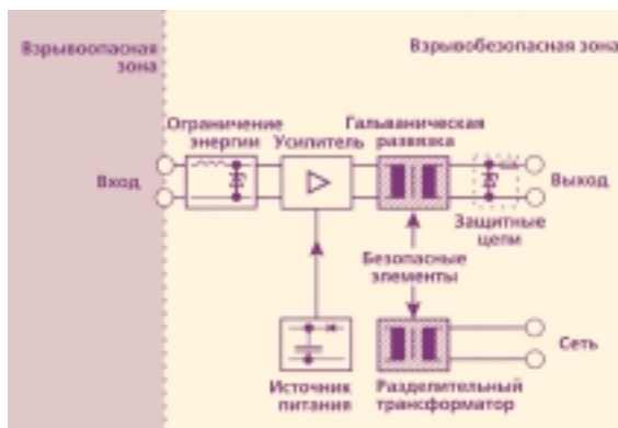
Рис. 15. Схема гальванически изолированного барьера
