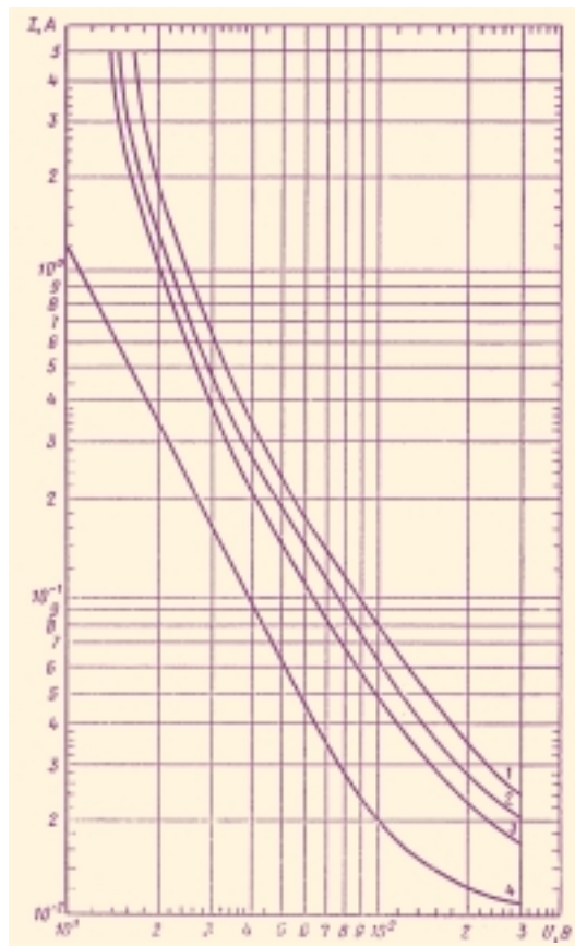
Рис. 3. Зависимости минимального воспламеняющего тока от напряжения источника в омической цепи (индуктивность менее 10 -4 Гн):
